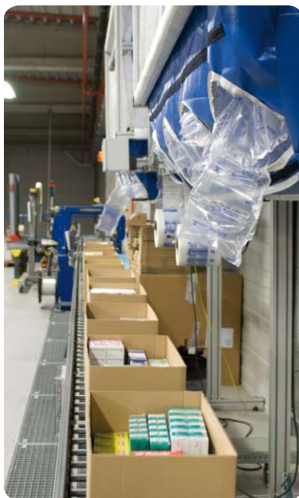
Avec les machines AIRplus®, le matériau est à tout moment à portée de main, du fait du remplissage permanent du silo par plusieurs entrées au-dessus du poste d'emballage.
