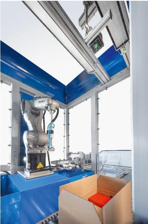
AUTO.PROTECT utilise un système de vision pour détecter les espaces vides dans la boîte et détermine le scénario d'emballage approprié à l'aide d'une IA précise et entraînée. **Image : Storopack.**
