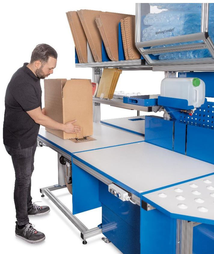
Sur les postes COMFORT.PACK, le distributeur de bande gommée humectée est intégré dans la surface de la table d'emballage de sorte que les cartons d'expédition puissent glisser facilement dessus. Photo : Storopack
