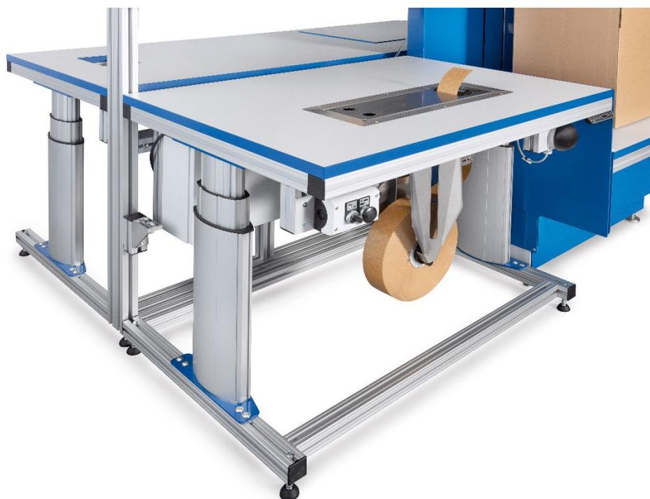
Sur les postes COMFORT.PACK, le distributeur de bande gommée humectée de Storopack est intégré dans la surface de la table d'emballage. Photo : Storopack
